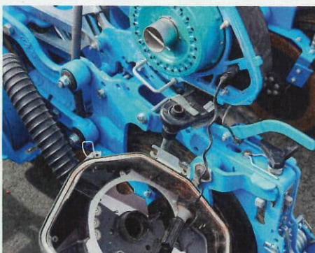
Les doseurs, disposés au-dessus de l'élément semeur, se composent de deux tambours de sélection précédés d'une trémie tampon.
