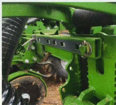
L'interrang est modifié en positionnant des brides dans les perçages correspondants. L'enfouisseur de fertilisant se décale avec l'élément semeur.
