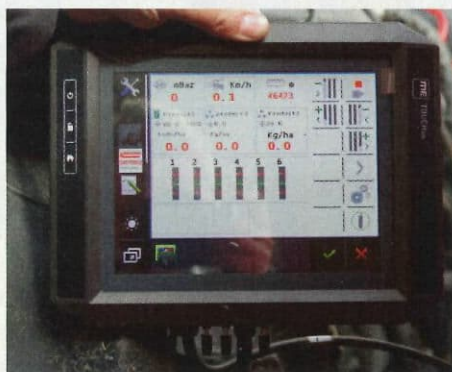
L'ensemble des réglages et l'affichage des informations du Chrono 306 s'effectuent par Isobus, directement depuis le terminal du tracteur ou sur l'écran Touch 800.
