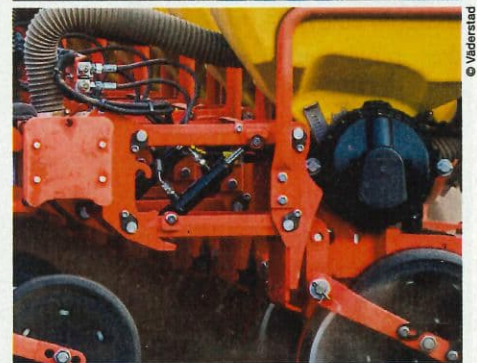
Un ressort, un vérin ou un coussin pneumatique assure le report de charge du châssis sur les organes d'enterrage.
