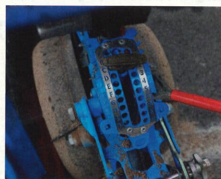
Afin de s'adapter à un large panel de profils de sol, les roues de jauge de 450 mm de diamètre du ValoTerra disposent de 19 réglages de profondeur de semis.
