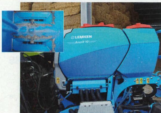
La trémie pressurisée de 600 L de l'Azurit 10 alimente pneumatiquement chaque élément via des vis sans fin indépendantes.
