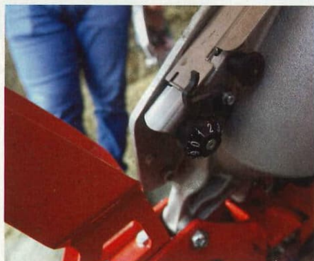
Les dents du sélecteur se règlent à l'aide de cette molette noire numérotée, prenant place derrière le corps de distribution.
