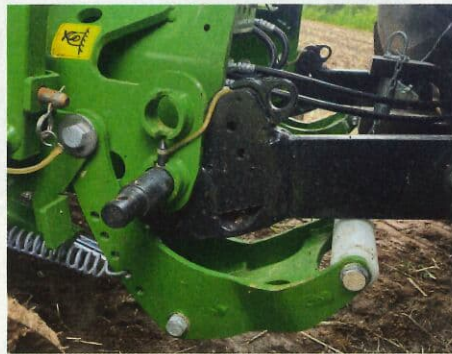
Le semoir utilise un système de report de charge en s'appuyant sur les bras de relevage du tracteur afin de gagner jusqu'à 600 kg de force de terrage.
