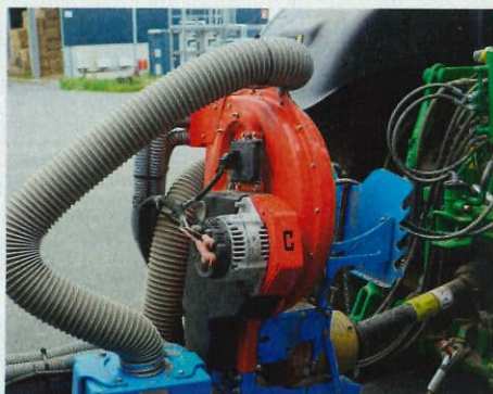
La prise de force du tracteur entraîne la turbine nécessaire à la dépression et à la production d'électricité via l'alternateur de 5,6 kW.
