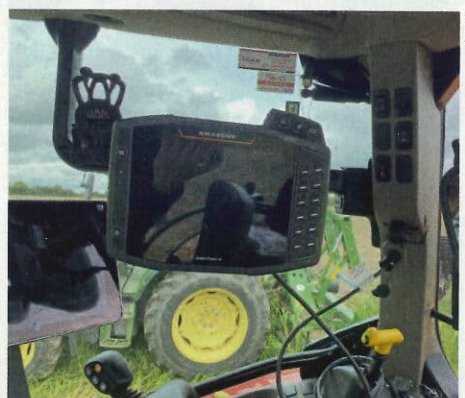
Amazone propose son boîtier Isobus AmaTron 4 pour le pilotage de son semoir. Ce terminal permet de gérer la modulation rang par rang.
