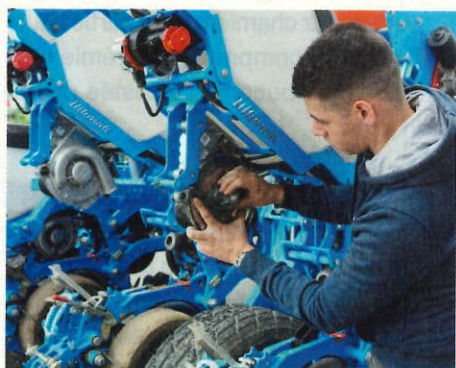
Le cœur du semoir, à savoir le disque sélecteur, est accessible à hauteur d'homme. Pour chaque élément, son changement s'effectue en une minute.
