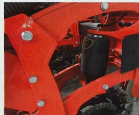
Sur chaque élément semeur, le ressort du parallélogramme est remplacé par un poumon d'air. L'ajustement de la pression s'effectue par le freinage pneumatique du tracteur.
