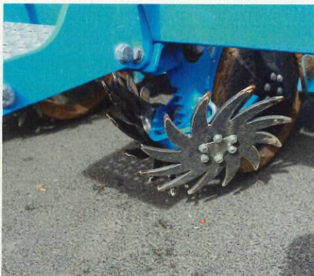
Pour préparer l'horizon de semis, l'Azurit 10 s'équipe de chasse-débris étoilés, à l'avant du coutre fertilisateur.
