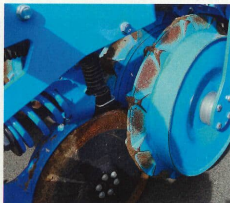
Deux rouleaux de type packer trapèze, de 500 mm de diamètre, supportent chaque élément et plombent le terrain avant l'ouverture du sillon.
