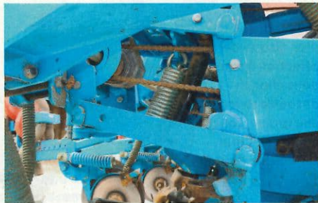
Sur un semoir mécanique, les roues placées entre les rangs assurent l'entraînement des éléments via des chaînes.
