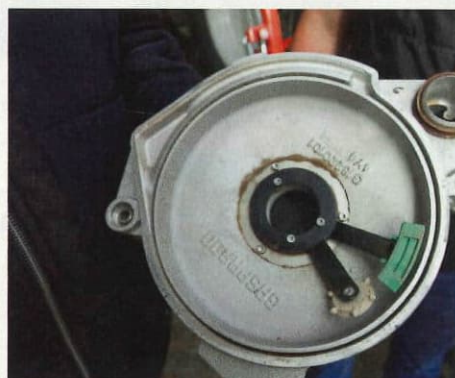
Le bol supérieur du corps de distribution contient la plaque coupant l'aspiration de la graine, ainsi que la roulette décrocteuse pour le disque à trous.
