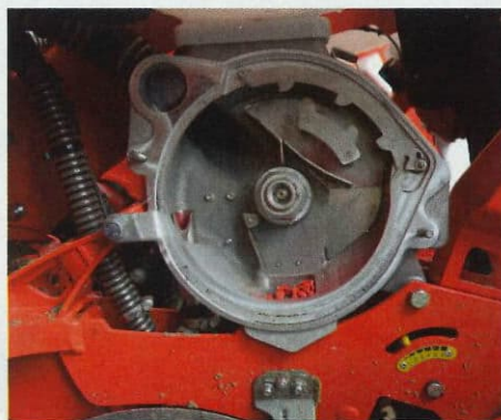
Le sélecteur se compose de cinq dents, dont deux fixes et trois réglables en partie supérieure. Elles permettent de dégrossir le flux de graines et d'éviter les doublons.
