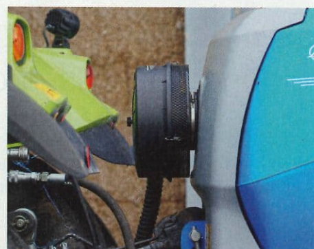
La turbine, alimentée par Power Beyond, fournit la puissance nécessaire au transport, à la sélection puis à l'éjection des graines.
