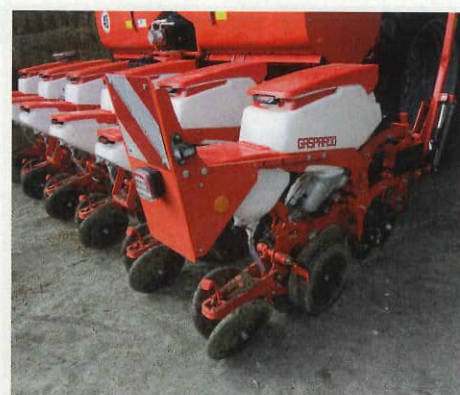
Chaque élément semeur se dote de deux trémies, l'une de 60 L pour la semence et l'autre de 16 L pour les microgranulés.
