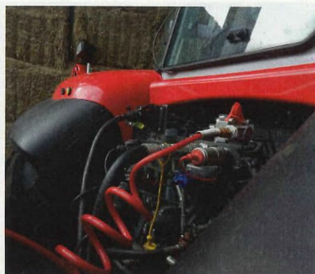
Le semoir doit être branché sur la prise de force, la prise Isobus, un distributeur en pompage continu et un simple effet.
