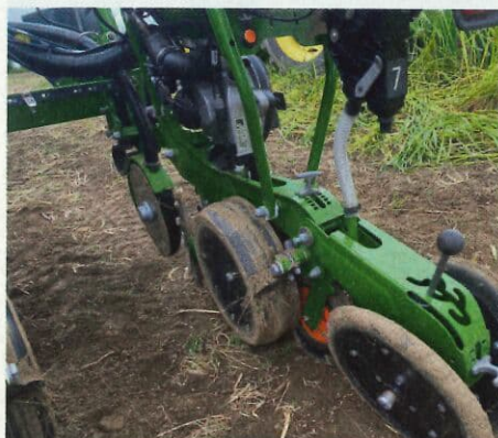
L'ensemble des réglages de profondeur et d'angle des roues de fermeture s'opère sans outil.
