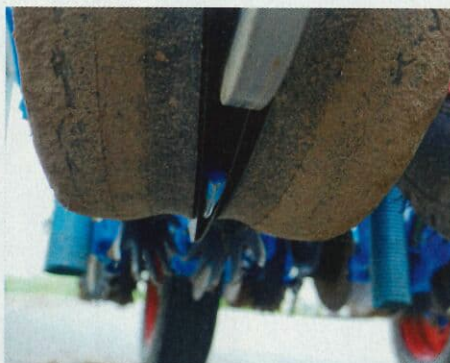
Le double disque ouvreur associé à la pointe de soc (en bleu) favorise le bon positionnement de la graine au fond du sillon.
