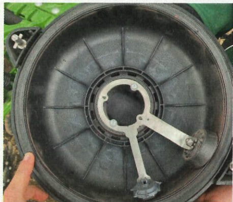
Le joint d'étanchéité tourne avec le disque de sélection grâce à un bol rotatif. Ceci efface toute friction et limite de fait l'usure.
