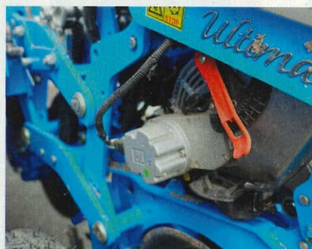
Chaque élément dispose d'un moteur électrique de 56 V en prise directe sur le disque.
