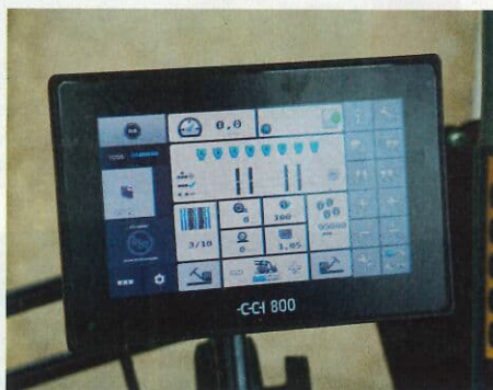
Le terminal Isobus permet de régler le semoir, notamment l'ajustement de la sensibilité en cas de manques ou de doublons.
