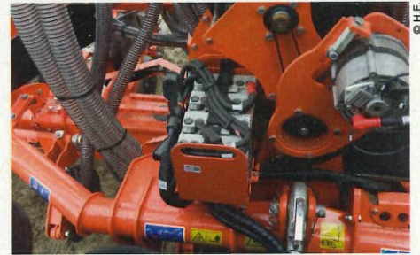
Un semoir à entraînement électrique puise son énergie directement sur le tracteur ou, comme ici, dans un circuit électrique embarqué.
