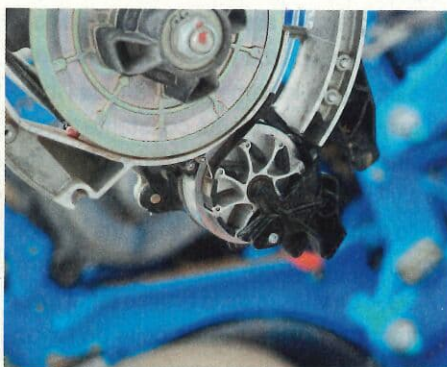
La roue de chargement alvéolaire accueille chaque graine une à une et l'insère avec régularité dans la courroie à brosse.
