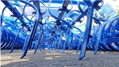
TYPE CF , beitels een geveerde tandarmen, voor met name de lichtere gronden
