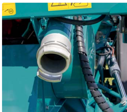
Vulbuis voor mechanische strooiboom (optioneel) en hydraulische strooiboom (standaard)
