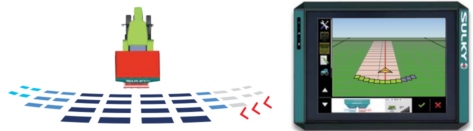
Wanneer de werkbreedte is verkleind, bijvoorbeeld gedurende de laatste werkgang, zullen de secties automatisch sluiten afhankelijk van de resterende werkbreedte (hier zijn 3 secties gesloten aan de rechterzijde)
