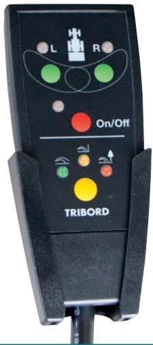
Bediening van het kantstrooien geïntegreerd in de remote control voor de bediening van de schuiven
