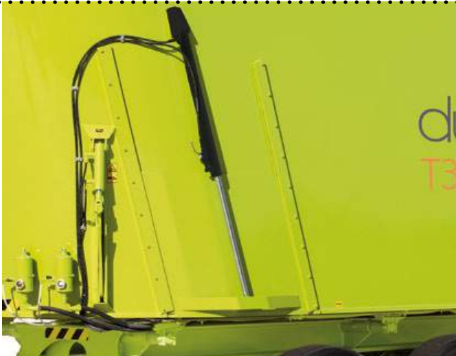
Seitenschieber für Direktaustrag Trappe de déchargement direct Directe losdeuren
