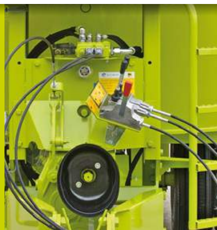
Zweistufiges Schaltgetriebe auch mit Bowdenzugbedienung erhältlich (Zubehör)
