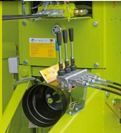
Zwei Bedienungsmöglichkeiten: elektrische Fernbedienung (Links) oder mechanische Bedienung über Bowdenzüge (Rechts)
