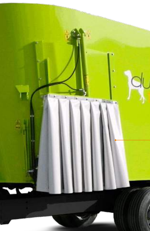
Standardausstattung mit Austragschieber Porte de déchargement directe standard Standaard directe losdeur
