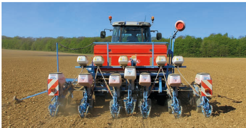
De 6/7 rijen Monoblock2 biedt rij-afstanden van 75 of 80 cm met 6 rijen of 56,2 en 60 cm met 7 rijen. Kunstmest is beschikbaar op zowel de versie met 6 en 7 rijen.
