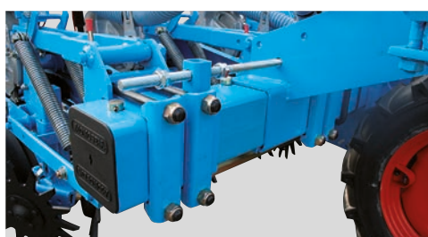
Boven de uitschuifbare balk zitten de aanslagen waar de rijafstand op elke gewenste breedte kan worden ingesteld.
