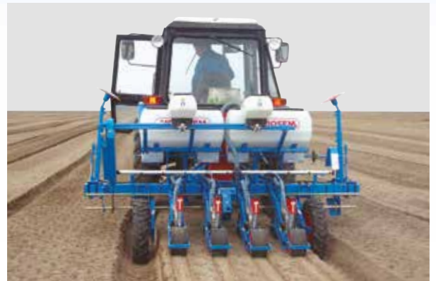
MS-A zaaier Monoblock vast frame 4 rijen met kunstmestopbouw en Microsem
