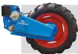
Geïntegreerde aandrijfkast in de wielunit Minimale rijafstand om unit te kunnen plaatsen is (1) 43 cm
