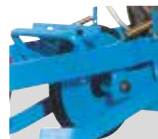
Tussendrukwiël met zelfreinigende soepele band
