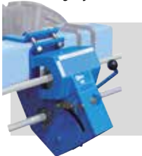
Centrale aandrijfkast Minimale afstand tussen de rijen om de kast te kunnen plaatsen (1) 33 cm
