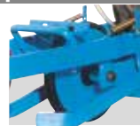
Tussendrukwielt met zelfreinigende soepele band
