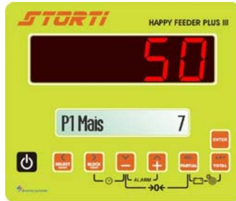
**MANAGING THE COMPONENTS/UNLOADING POINTS BY USING THE MINUS AND PLUS KEYS**
