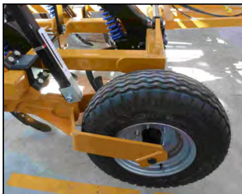
Figura 5-1. Ruota di appoggio anteriore laterale
