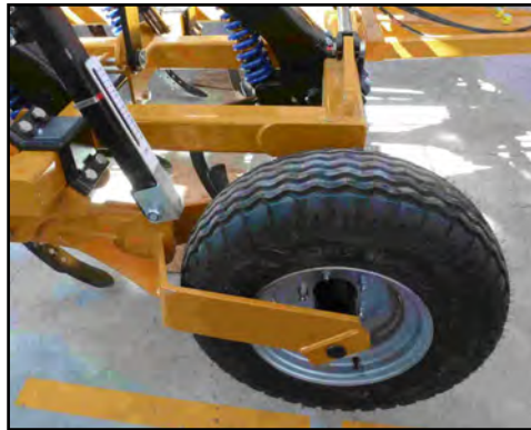
Figure 5-1. Roue de support latérale
