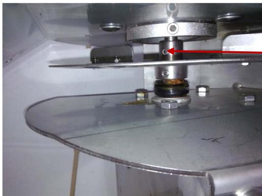
2. Öffnen Sie die Wurmverschraubung, welche das Rührwerk hält.
