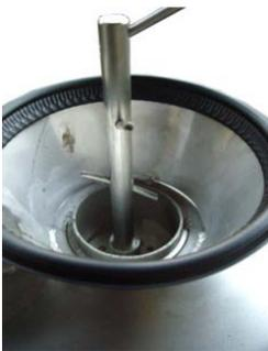
Beim Streuen von grobkörnigem Salz muss der Splint mittig geschlagen werden (wie auf dem Foto) Bei feinkörnigem Salz muss der Splint nach unten geschlagen werden. Kontrollieren Sie auch gelegentlich die Silikonabdichtung des Trichters an der Schweißnaht. Ist diese defekt kann Wasser eintreten und das Salz setzt sich fest.
