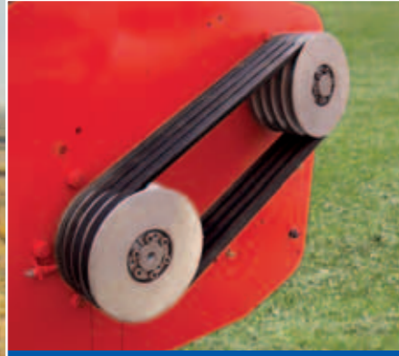
Correas de transmisión 4 hasta 2,30 m. - 5 desde 2,65 m. Courroies d'entraînement Drive belts
