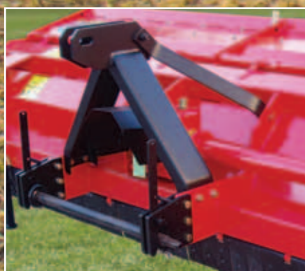
Tercer punto y enganche automático (a partir de 2,65 m.) 3-point et attelage automatique (largeur de travail 2,65 m. et supérieur) 3-point hitch and automatic coupling (from 2,65 m)
